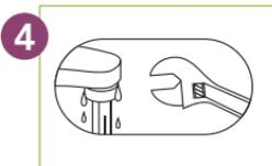
4. Abre la llave del agua. Si el aireador gotea, usa la llave inglesa para apretarlo hasta que quede ajustado. Usa un trapo para proteger el acabado. **NO LO APRIETES DEMASIADO.**
